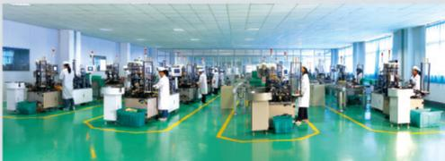
**Assemblaggio:** usiamo 280 macchine a controllo numerico con tecnologia giapponese ed europea. Effettuiamo test di risonanza e vibrazione su tutti i cuscinetti prima che lascino le nostre fabbriche.
